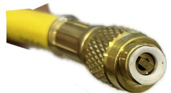
Nota: Si al colocar la manguera no llega a pinchar regule el depresor para que pinche el ovulo. Los depresores de las mangueras son a rosca si los desenrosca el depresor sale hacia afuera y pincha el ovulo
