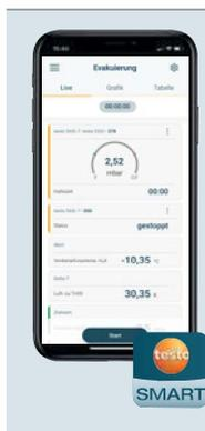
La App testo Smart guía rápida y fácilmente por las mediciones en los sistemas de frío, climatización y calefacción.
