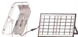
3) Conecte la lámpara al panel solar con los cables. Utilice el cable de extensión cuando la distancia de la instalación sea más de 1M (De acuerdo a las cuestiones de potencia y seguridad, se recomienda que el largo del cable sea <4 metros. Si el largo del cable es >4 metros, se podrían producir problemas tales como carga insuficiente o extenso)
