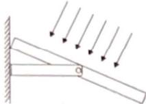
2) Fije y ajuste el ángulo del panel solar de acuerdo a la instalación de la lámpara. Instale el panel solar bajo pleno sol durante el día pero sin erradicación de luz durante la noche.
