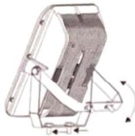
1) Fije la lámpara de acuerdo con las normas nacionales para asegurarse de que no se caiga. Ajuste el soporte móvil en la posición adecuada. (Ángulo de rotación: 0 grados - 180 grados)
